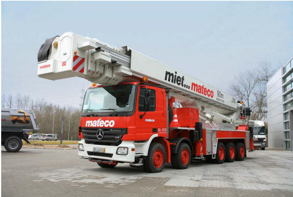
**Abb. 1.2** Fünfachsiges Fahrwerk mit 5. Achse als gelenkte Nachlaufachse für Sonderaufbauten (Daimler AG)
