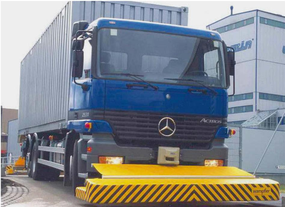
**Abb. 1.31** Innerbetrieblicher fahrerloser Transport mit automatischem Materialumschlag mit dreiachsigem Mercedes-Benz Actros (Daimler AG)
