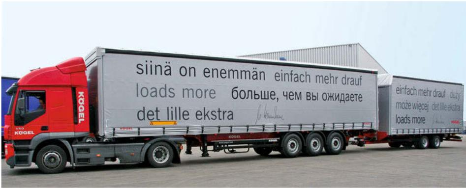
**Abb. 1.5** Volumenzug „long truck“ von Kögel mit einer Länge von 25,25 m. Zunächst als Praxisversuch mit 40 t Gesamtgewicht zugelassen (Kögel)
