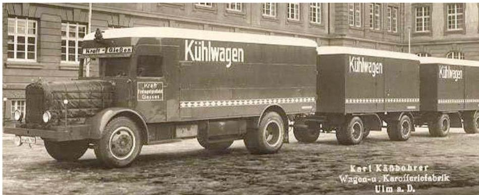
**Abb. 1.3** Untermotorisierter Lastzug 1936 von Henschel/Kässbohrer mit 125-PS-Dieselmotor, 34 t Gesamtgewicht (3,7 PS/t) (Karl Kässbohrer GmbH)
