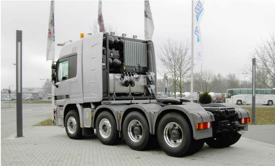
**Abb. 1.4** Schwerlastzugmaschine Actros-SLT (8×4/4) mit V8-Motor mit 480 kW. Zusatzkühlanlage hinter dem Fahrerhaus (E. Hoepke)
