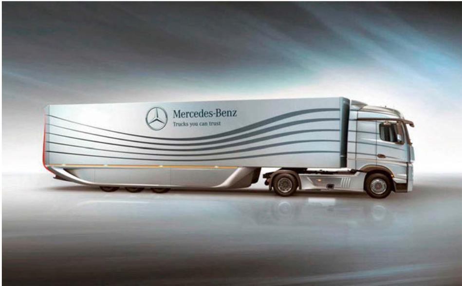
**Abb. 1.6** Designstudie Aerotrailer spart im Jahr ca. 2000l Dieselkraftstoff und mehr als 5 t CO<sub>2</sub> (Daimler AG)
