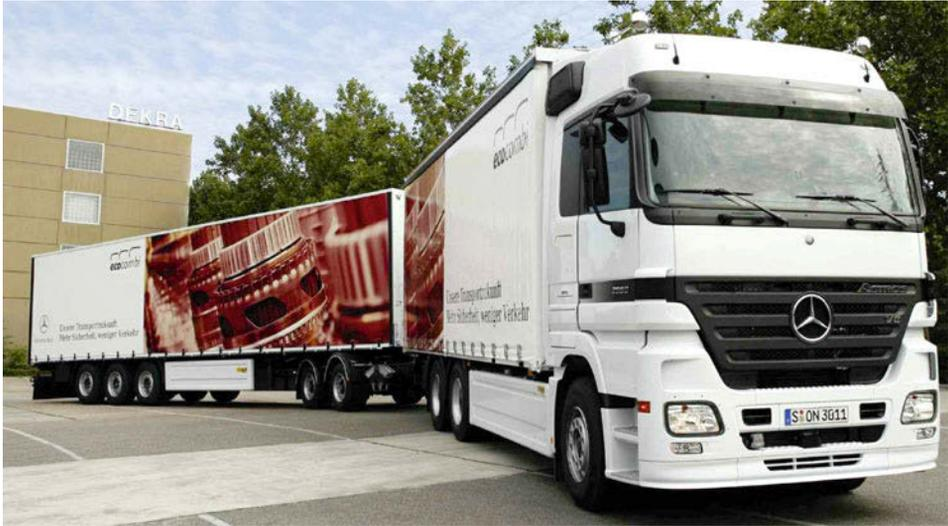
**Abb. 1.30** Modellversuch 2006: Eco-Combi von Mercedes-Benz mit acht Achsen, 60 t Gesamtgewicht und 25,25 m Länge. Mercedes-Benz Actros mit 440-kW(598-PS)-Dieselmotor, ca. 10 PS/t (Daimler AG)
