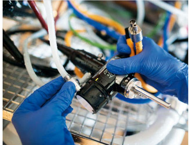
Abb. 2.3 Konnektieren des Dichtigkeitstesters im RGD-E. (Paavo Bläfield)
