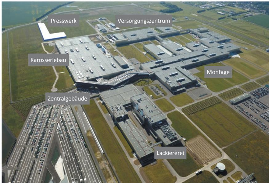
**Abb. 1.4** Werkstruktur BMW Werk Leipzig (Quelle: BMW)
