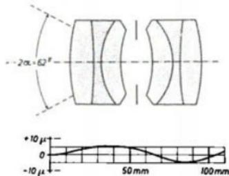
Abb. 8. Normalwinkel-Objektiv (Orthoprotar) von Jenoptik Jena,  $1:25$ ,  $f = 19$  cm, für terrestrische Aufnahmen ( $2/3$  nat. Größe) mit Verzeichnungskurve.
