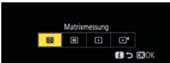
Die Belichtungsmessmethode kannst du hier einstellen. In den meisten Fällen kannst du die Matrixmessung verwenden. Sie führt fast immer zu einem guten Ergebnis, das du, wenn nötig, mithilfe der Belichtungskorrektur noch verbessern kannst. Die anderen Messmethoden sind für speziellere Anwendungen. Spot- und die lichterbetonte Messung sind z. B. gut für Theater- und Konzertfotografie geeignet.
