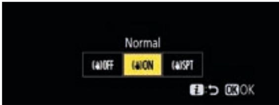
Deine Kamera besitzt eine eingebaute Sensorstabilisierung. Manche Objektive haben zusätzlich einen optischen Bildstabilisator (VR). Hier deaktivierst du die Stabilisierung, wenn du ein Stativ verwendest, oder stellst auf „Sport“ um, wenn du z. B. Rennwagen oder Vögel am Himmel mit der Kamera verfolgst.
