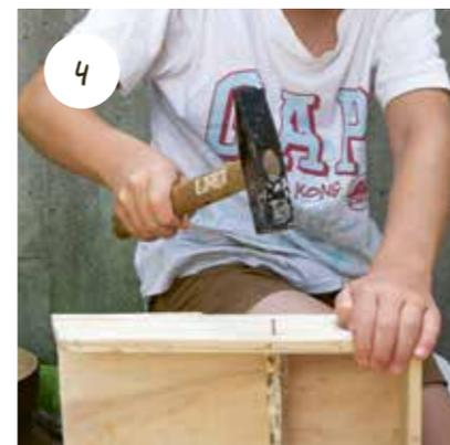
Leg das Gitter beiseite und stell den Kasten aufrecht hin, dabei die Bodenplatte festhalten. Mit je 2 Nägeln befestige die Seitenwände an die Bodenplatte.
