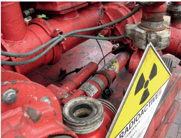
Bohrfahrzeug mit integrierter radioaktiver Mess-Sonde
